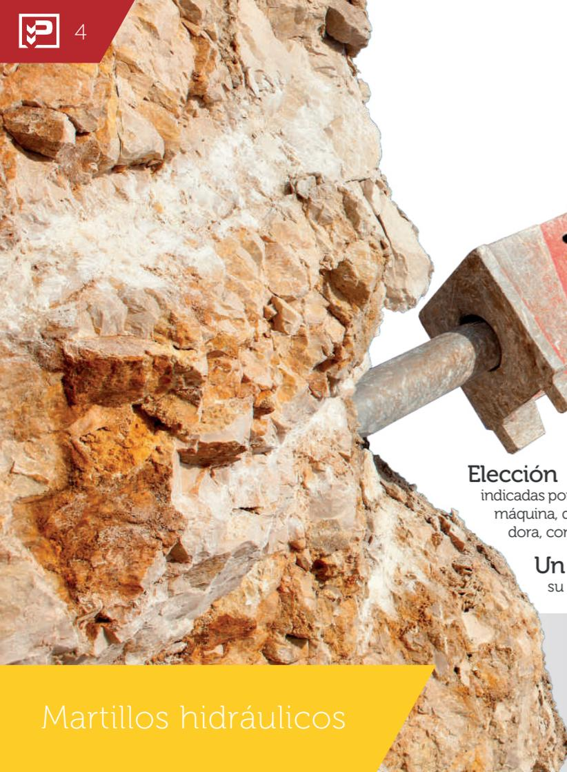
**Elección del martillo,** Teniendo siempre en cuenta las especificaciones indicadas por el fabricante de la excavadora, la elección adecuada del martillo para su máquina, depende de una serie de factores: peso y flujo hidráulico de la excavadora, configuración del brazo y del stick, uso al que va destinado.
